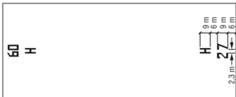
Bild 16. Utformning och proportioner på siffror och bokstäver på banliknande FATO.
